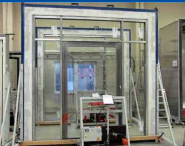
Ensayo larga duración s/ EN 1191
